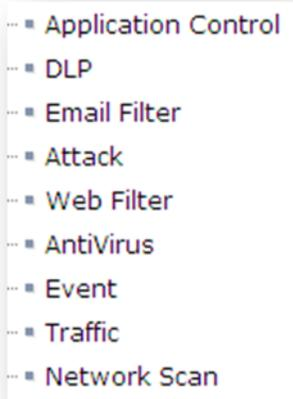
Les catégories ainsi que les niveaux de logs requis (Debug, Information, Notification, Warning, Error, Critical, Alert, Emergency) sont sélectionnables depuis la GUI et configurables sur chacun des supports de stockage. Ainsi est il possible de stocker sur le disque dur tous les logs de la catégorie traffic pour déboguer une congestion (niveau debug) mais ne conserver que les logs « évènements critiques » sur la mémoire.
