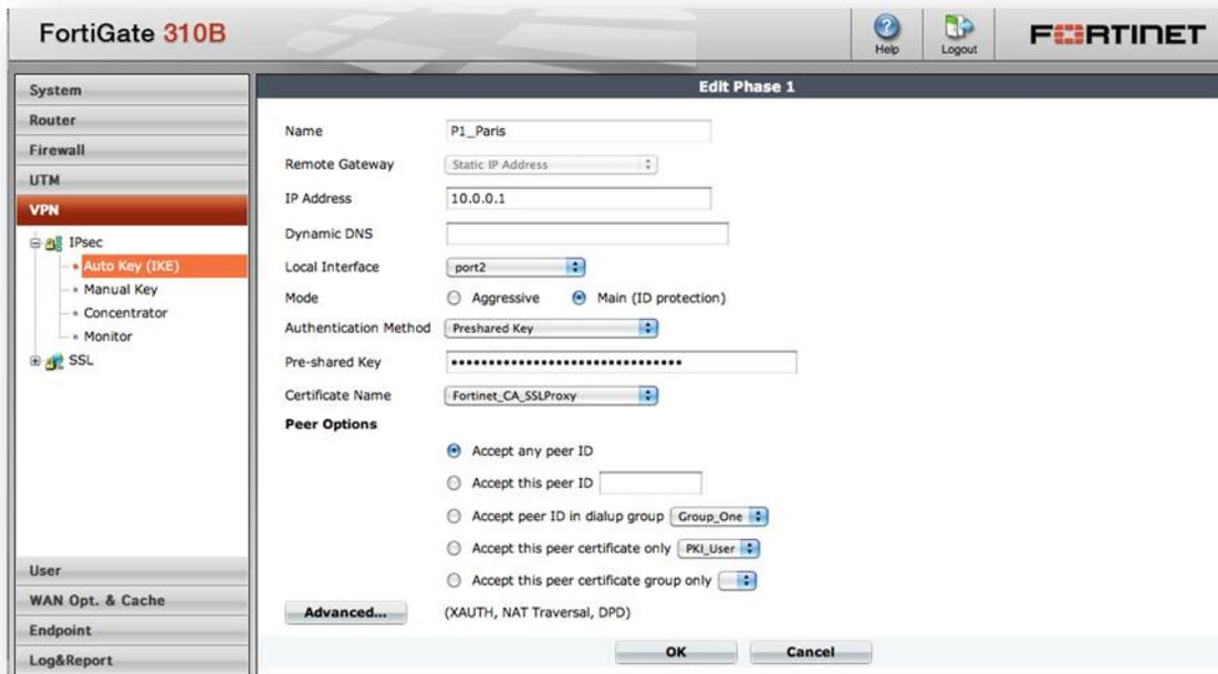
L'authentification du tunnel est réalisée par mot de passe (pre-sharedkey), ou par certificats digitaux. Une authentification utilisateur de type XAUTH (reposant sur les différents référentiels d'utilisateurs supportés par FortiOS) peut être adjointe à celle du tunnel. Le module VPN IPsec permet de configurer les réseaux privés en fonction des contraintes opérationnelles et autorise l'implémentation des différentes topologies rencontrées :
