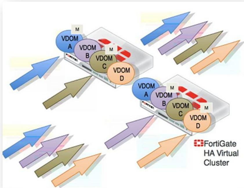
L'autre moyen permettant la mise en œuvre de clusters dont tous les nœuds traitent du trafic est d'utiliser le mode A-A. Le nœud maître peut alors utiliser un algorithme de partage (round robin, weighted round robin, random, ip ou port, etc.) distribuant la charge sur les autres nœuds. Lorsque les équipements sont munis de l'ASIC FortiASIC Network Processor, le trafic redirigé est accéléré si bien que les ressources CPU du maître ne sont plus sollicitées pour les sessions établies.
